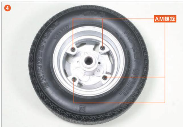
在確保雙側的輪圈不會移位的同時，使用 **AM 螺絲** 在4個位置進行螺絲固定。
