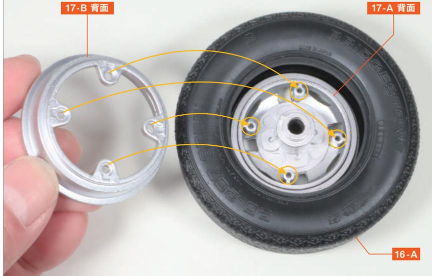
在按住 17-A 避免讓它脫落的同時，將其翻轉過來，將內側輪圈 17-B 內側的凹槽對齊 17-A 螺絲孔上的突起部分，然後嵌入。
